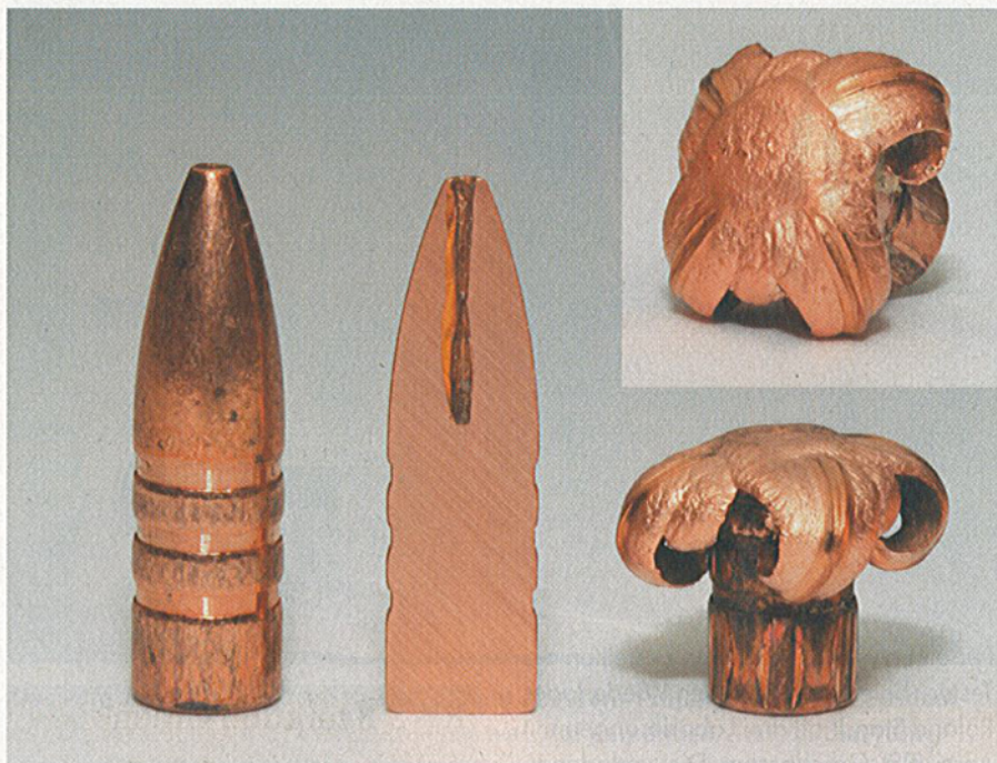
Das "Vor-TX TSX FB" in .223 Remington verlädt der US-Hersteller Barnes in Fabrikpatronen. Das TSX-Deformationsgeschoss mit zylindrischem Heck (FB= Flatbase) besteht vollständig aus Kupfer. Führungsbänder reduzieren die Reibung im Lauf. Im Test pilzte das Geschoss vorbildlich auf und verlor im Ziel keine Splitter.
